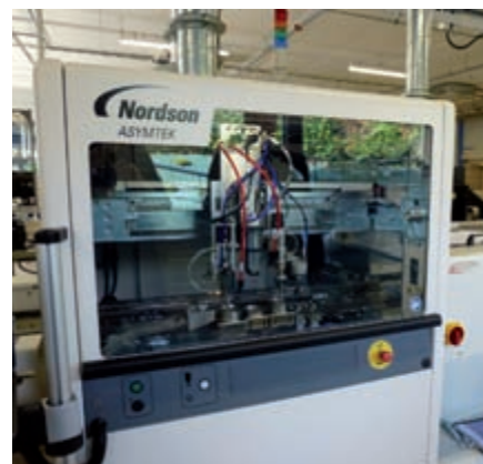
Il laboratorio di produzione delle schede elettroniche è attrezzato con una nuova macchina per verniciatura, che permette di limitare i depositi di polvere, la corrosione. Tutte le schede di GYS saranno verniciate, criterio importante per le zone dove esiste un forte tasso di umidità.
