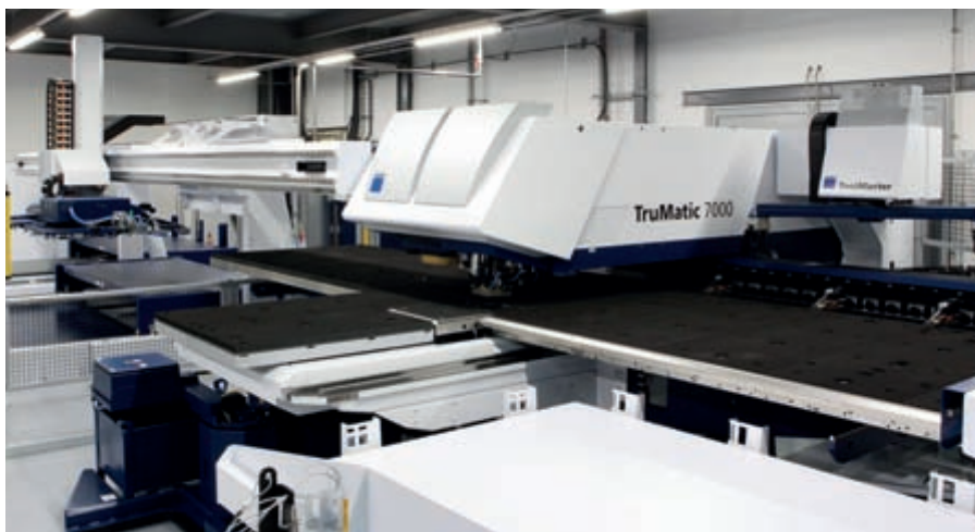
Tra i recenti investimenti, qui nel laboratorio sulle lamiere, questa nuova macchina a doppia testa, è in grado di effettuare contemporaneamente la punzonatura e il taglio laser. Ciò permette di lavorare pezzi di spessore più importante, con un risparmio di tempo ed una maggior qualità di taglio.
