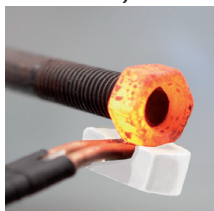
Løsne rustne bolter
