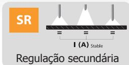
**Regulação secundária** - Independentemente da tensão de entrada e as variações em distância entre o eléctrodo e o metal, a máquina assegura um arco estável de elevada qualidade.
