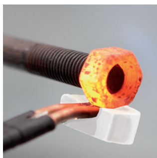
Lossar rostiga skruvar
