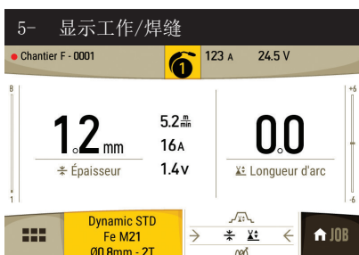
屏幕左上方显示工作名称及焊缝编号。 (焊缝编号自动添加且不可修改)。
