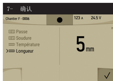
可在屏幕上点击确认或通过扣动焊枪扳机进行确认。
