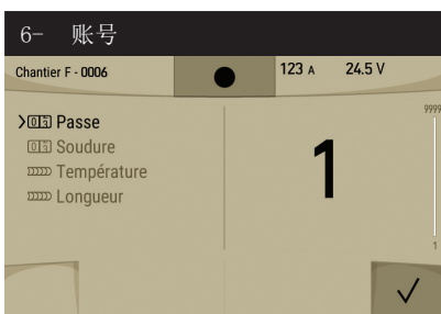
每次焊接结束，识别窗口显示： 焊道编号，焊接编号，零件温度与/或焊缝长度。
