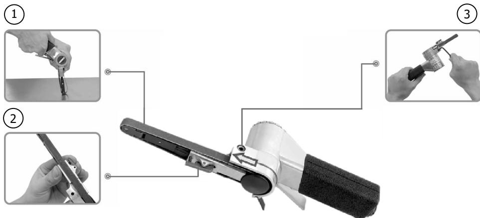
Pressez le bouton latéral et appuyez légèrement l'extrémité de la ponceuse pour réduire la tension de la courroie. Retirer la courroie abimée et remplacée-la par une neuve :
