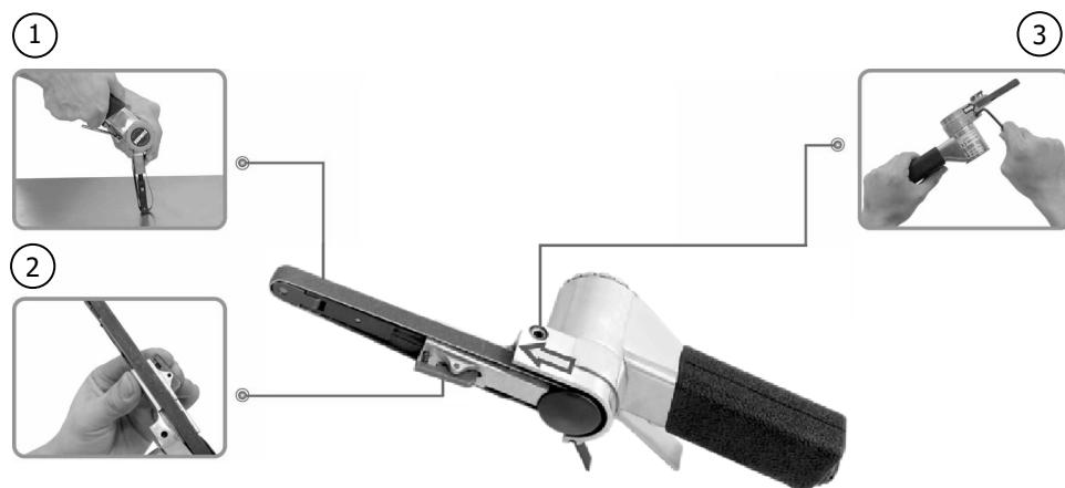
Drücken Sie den Seitentaster und das Ende der Schleifmaschine leicht an, um die Riemenspannung zu reduzieren. Entfernen Sie den beschädigten Riemen und ersetzen Sie ihn durch einen neuen:
