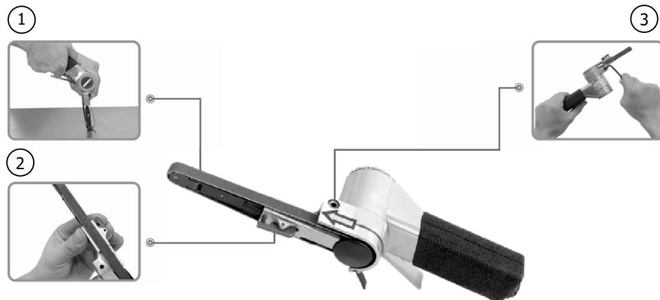
"Druk op de knop op de zijkant van het apparaat en druk lichtjes het uiteinde van de schuurmachine om de spanning op de schuurband te verlichten. Verwijder de beschadigde band en vervang deze door een nieuwe :
