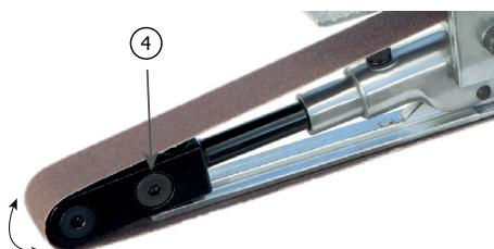
Si la banda no está centrada en el soporte, gire el tornillo (4) con una llave hexagonal.
