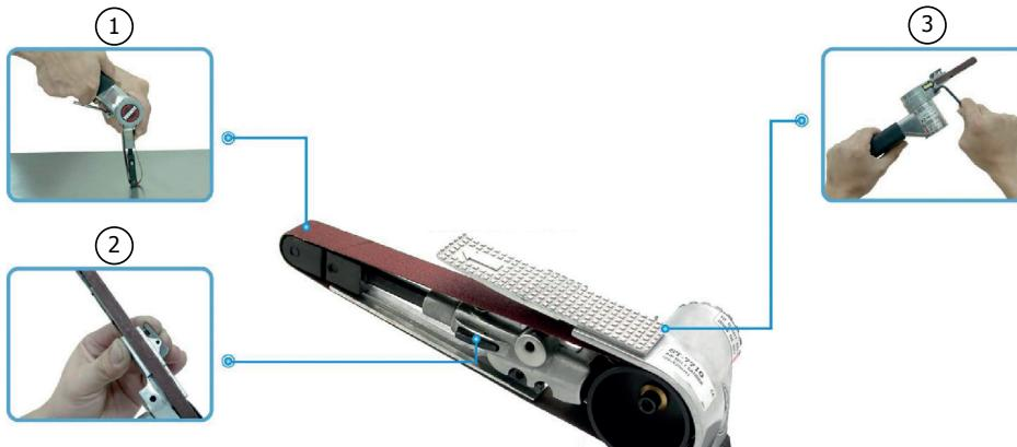
Drücken Sie die seitliche Taste und drücken Sie den Bandschleifer leicht, um die Spannung des Schleifbandes zu reduzieren. Entfernen Sie das beschädigte Schleifband und ersetzen Sie es durch ein neues:
