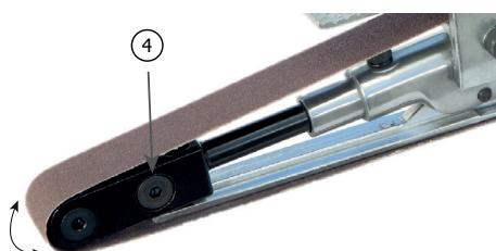
Si la bande n'est pas centrée sur le support, tournez la vis ④ à l'aide d'une clé hexagonale.
