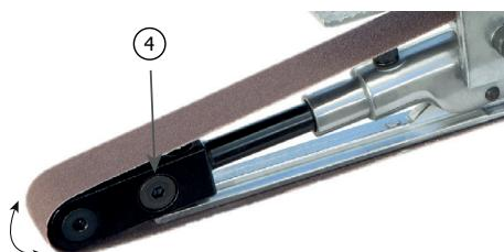
Если лента не отцентрирована на кронштейне, поверните винт (4) шестигранным ключом.
