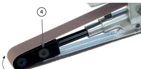
Wenn das Schleifband nicht zentriert aufliegt, so drehen Sie die Schraube mit einem Sechskantschlüssel.
