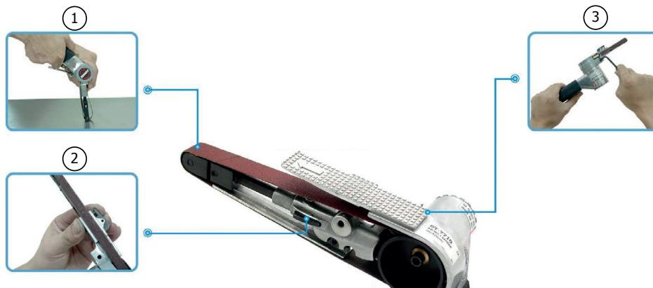
Pressez le bouton latéral et appuyez légèrement l'extrémité de la ponceuse pour réduire la tension de la bande. Retirer la bande abimée et remplacée-la par une neuve :
