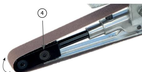
Als de band niet is gecentreerd op de houder, draai aan de schroef (4) met behulp van een inbussleutel.
