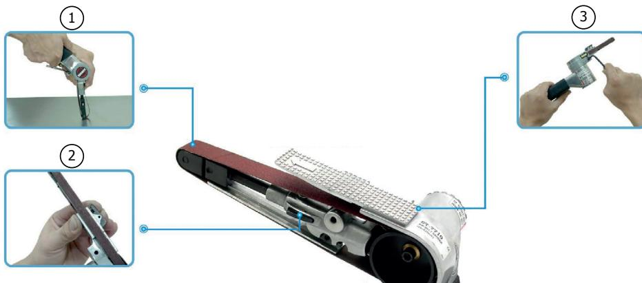
Presione el botón lateral y presione ligeramente la extremidad de la lijadora para reducir la tensión de la correa. Retire la banda dañada y sustitúyala por una nueva:
