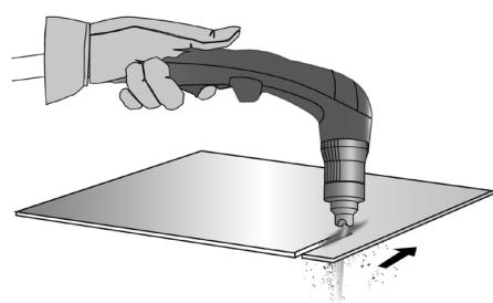
**PERFORACIÓN DE UNA PIEZA / CORTE DESDE EL CENTRO DE UNA PIEZA**
