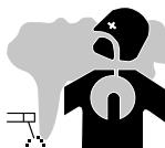
Den svetsrök, gaser och damm som produceras under svetsning är farliga. Det är obligatoriskt att säkerställa tillräcklig ventilation eller utsugning för att leda bort rök och gaser från arbetsområdet. I händelse av otillräcklig lufttillförsel på arbetsplatsen rekommenderas en hjälm med lufttillförsel.
