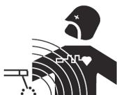
De elektriska strömmar som flyter genom en ledare orsakar elektriska och magnetiska fält (EMF). Svetsströmmen genererar ett EMF fält runt svetsningskretsen och svetsutrustningen.
