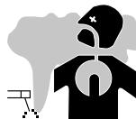
Røg, gasser og støv, som produceres under svejsning er farligt. Det er obligatorisk, at sikre tilstrækkelig ventilation og/eller udsugning, for at holde røg og gasser væk fra arbejdsmrådet. Det anbefales at bruge en luftforsyning i tilfælde af utilstrækkelig lufttilførsel på arbejdsplassen.
