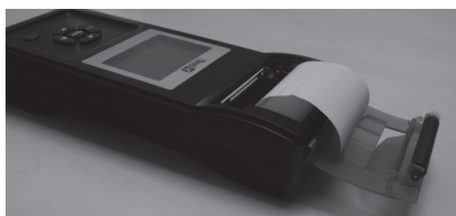
B. Posizionare un nuovo rotolo di carta nell'alloggiamento.
