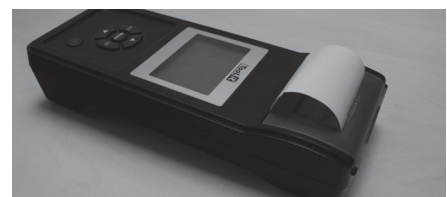
C. Papier ein wenig aus dem Papierfach herausziehen und auf den transparenten Deckel drücken, um ihn zu schließen.
