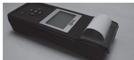
С. Поместите небольшой отрезок бумаги из бумаги из отсека и прижмите прозрачную крышку к крышке закрывается.
