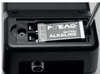
Verwijder de batterij door deze omhoog te wippen met een schroevendraaier
