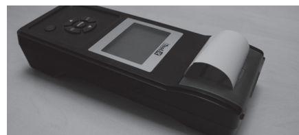
C. Placer une petite longueur de papier du compartiment et appuyer sur le couvercle transparent pour fermer.
