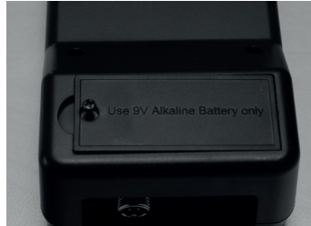
Desatornillar totalmente el compartimiento de las pilas
