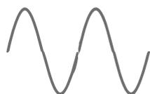
**PSW (Pure Sine Wave)** : i modelli PSW consegnano una tensione stabile, della stessa qualità della rete elettrica. Possono alimentare tutti gli apparecchi, anche i più sensibili (neon, televisione, computer fisso, ecc...)
