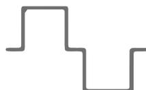
**MSW (Modified Sine Wave)** : I modelli MSW generano un'onda alternata modificata. Sono adatti per ricaricare la maggiorparte degli elettrodomestici e degli apparecchi elettronici come i telefoni, le macchine fotografiche, i computer portatili, l'illuminazione....
