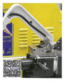
GYS: Die automatische Punktschweißanlage BP.LQC-S7 verschweißt hochfeste UHSS und Boronstähle mit maximal 13.000 Ampere bei einem Anpressdruck von bis zu 550 daN. Die Bügel werden inklusive Wasserkühlung mit einem Schnellverschluss befestigt. Die Elektrode kann der Anwender bei Bedarf einfahren, um auch in "verwinkelte" Ecken zu gelangen.
