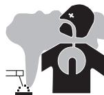
Dampen, gassen en stof uitgestoten tijdens het lassen zijn gevaarlijk voor de gezondheid. Zorg voor voldoende ventilatie, soms is toevoer van verse lucht tijdens het lassen noodzakelijk. Een lashelm met verse luchtaanvoer kan een oplossing zijn als er onvoldoende ventilatie is.
