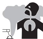
Выделяемые при сварке дым, газ и пыль опасны для здоровья. Вентиляция должна быть достаточной, и может потребоваться дополнительная подача воздуха. При недостаточной вентиляции можно воспользоваться маской сварщика-респиратором.
