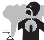
I fumi, gas e polveri emessi dalla saldatura sono pericolosi per la salute. È necessario prevedere una ventilazione sufficiente e a volte è necessario un apporto d'aria. Una maschera ad aria fresca potrebbe essere una soluzione in caso di aerazione insufficiente.
