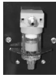
Pneumatisch filter, Aansluiting pneumatisch netwerk
