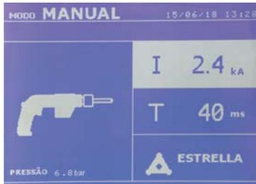
No modo **MANUAL**, a intensidade máxima admitida será de 9 kA durante um período que não pode exceder 600 ms. As configurações que aparecem na tela serão bloqueadas nesses valores máximos. Ajuste o gerador especificando a espessura da chapa a ser soldada pelas teclas + e -. É possível modificar os parâmetros da corrente e do tempo no modo manual.
