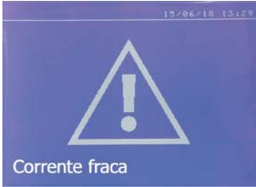
Se a corrente obtida durante um ponto for inferior ao valor do setpoint (6%), a máquina indica, uma vez efetuada o ponto uma mensagem de aviso de "corrente fraca" que o convida a verificar o ponto.
