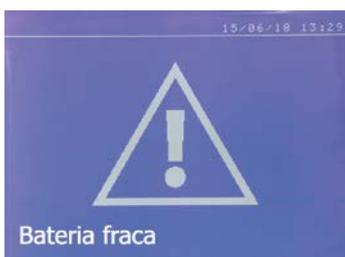
A mensagem "Bateria fraca" aparece quando a máquina é ligada e alerta o usuário de que a bateria no cartão de controle está fraca. Esta bateria garante a proteção da data e hora em que o equipamento é desligado.
