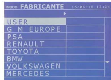
Pontos de soldadura programados pelo usuário podem ser chamados novamente, selecionando USER na lista de fabricantes. Os pontos de soldadura podem ser programados graças ao software GYSPOT e ao módulo de configuração de pontos de soldadura
