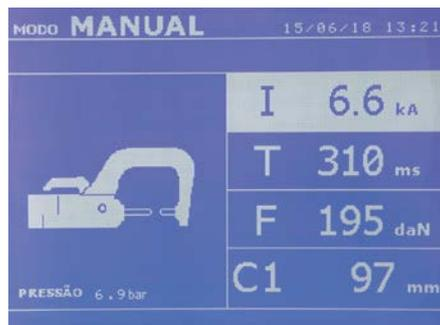
Este modo aparece por padrão ao arranque a máquina. Permite fazer um ponto facilmente, escolhendo:
