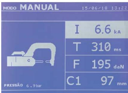
As configurações propostas por padrão no modo manual correspondem a uma conversão das configurações feitas no modo normal (conversão da espessura e do tipo de chapa em intensidade, tempo de soldadura e esforço).
