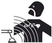
A corrente elétrica que passa por qualquer condutor produz campos elétricos e magnéticos (EMF) localizados. A corrente de soldadura, gera um campo eletromagnético em torno do circuito de soldadura e do material de soldadura.
